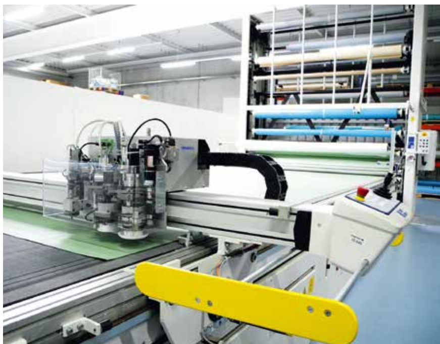
Seit Bieri Alpha ein verfahrbares Paternoster-Lagersystem einsetzt, spart das Unternehmen täglich bis zu vier Arbeitsstunden beim Wechsel der PVC-Folienrollen für den CNC-Cutter (Bilder:
