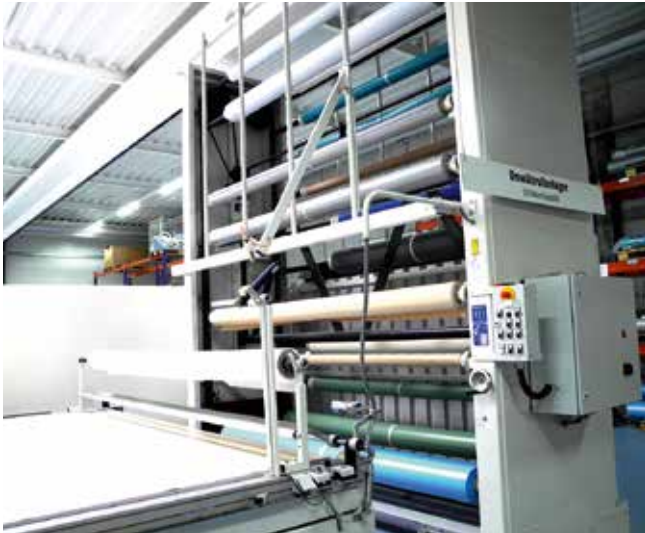
Einmal in der Woche beladen die Mitarbeiter die 22 Tragegestangen des Paternosters mit Rollen in den sieben Farben und mit der Netzfolie
