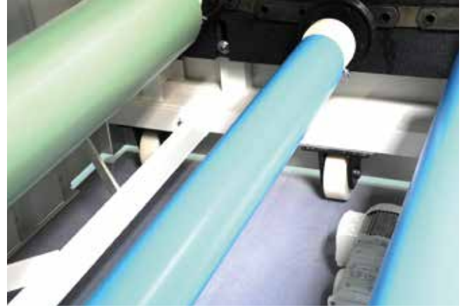
Verfahrbares Lagersystem auf Rollen: Automatisch, mithilfe einer sensorgesteuerten Kantensteuerung, oder manuell kann der Paternoster am Kopf des CNC-Cutters seitlich um mehrere Zentimeter verfahren werden
