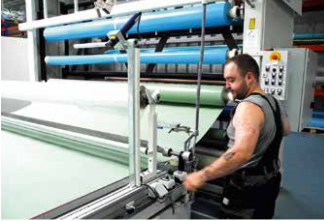
Ein Laser gibt die Linie vor, an der der Rand der Folie anliegen muss, damit die Präzision bei Schnitt gewährleistet ist. Im Bild Stefan Degenkolbe, technischer Konfektionär und Abteilungsleiter Rollschutzfertigung, beim Einrichten
