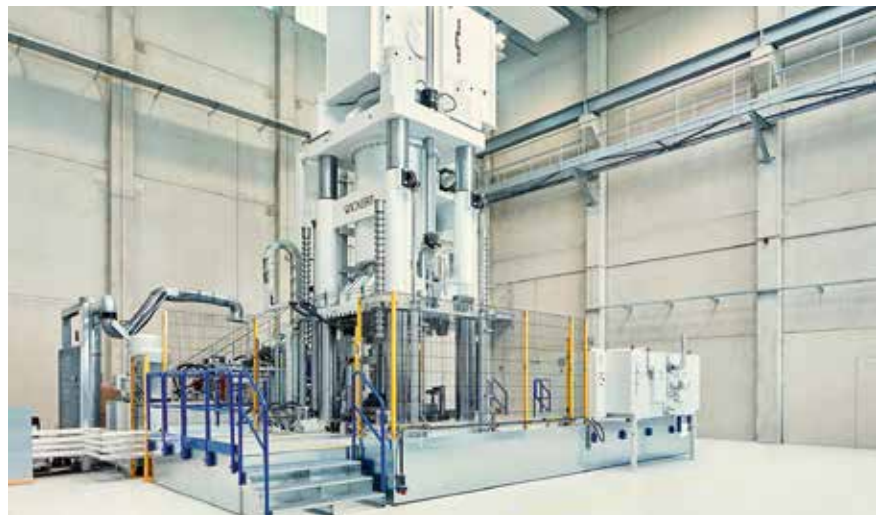
WKP 25000 S: Die Composite-Pressen ist rundum zugänglich und kann von zwei Seiten bedient werden (© TU Chemnitz)
